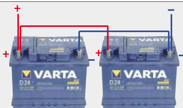
Fig. 2 Parallellkopplade batterier, 12 V
